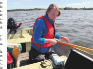
Med ett särskilt instrument mäter Emma Johansson temperatur, syrehalt och ljus på olika djup.
